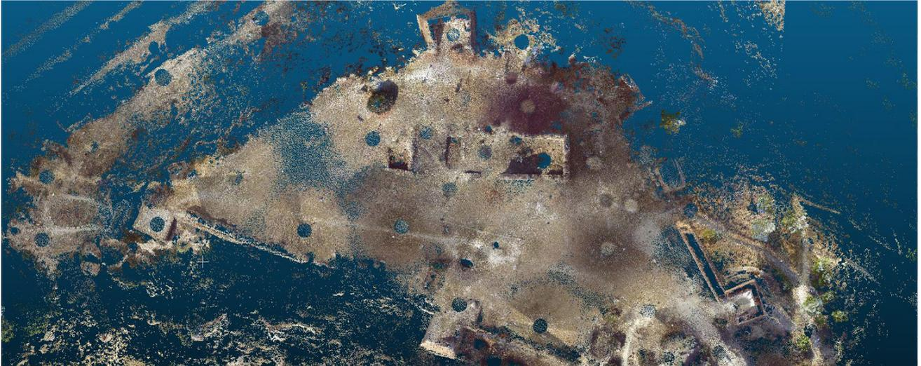
Fig5. Planta de la nube de puntos extraída del escáner láser
