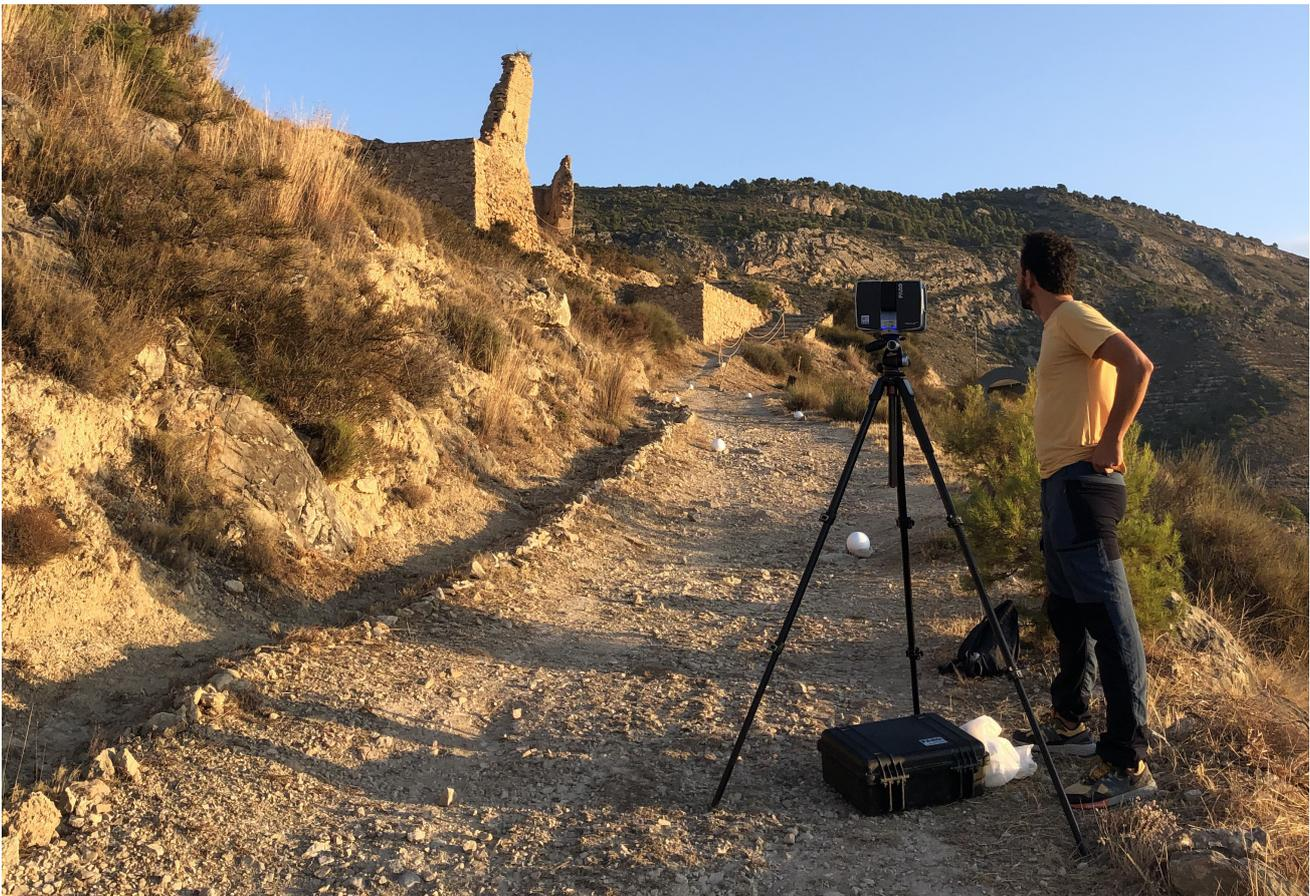
Fig2. Toma de datos mediante el escáner FARO Focus 3DS120.
